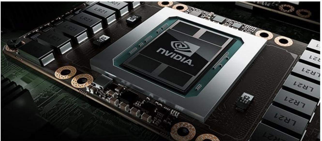
presenta hasta 2TB de memoria coherente a la que se puede acceder ya sea mediante la GPU o la CPU, por lo que el ancho de banda es un requisito fundamental. Nvidia equipó la parte inferior del GV100 con dos conectores mezzanine. Un conector proporciona energía y se adapta al tráfico PCIe y de banda lateral, mientras que el otro está dedicado a la conexión
