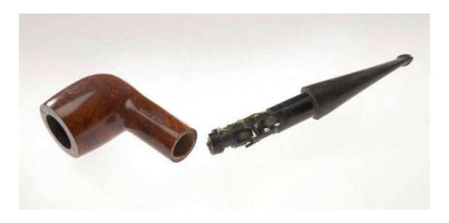
Esta pipa de tabaco modificado no sería una buena herramienta para fumar, ya que el cañón contiene una antena de radio sensible. Con la **boquilla de la pipa entre los dientes**, la operativa serviría el escuchar las transmisiones de audio enviados a través de la **conducción ósea** a través de su mandíbula. Sin duda, estos espías debieron de hacer unos cuantos gestos durante la misión.
